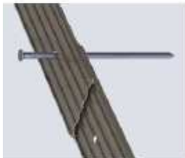
Połączenie na zakładkę, zabezpieczone gwoździem.
